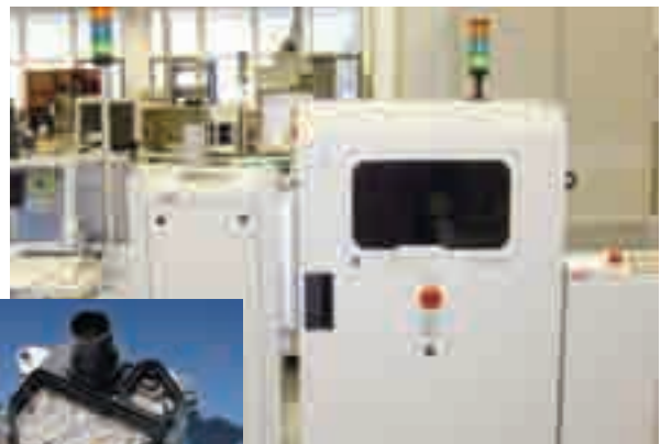
Oben: Viscom-Inspektionssystem C6053BO in der Fertigung Links: Vorort-Steuergerät für stufenlose Getriebe
