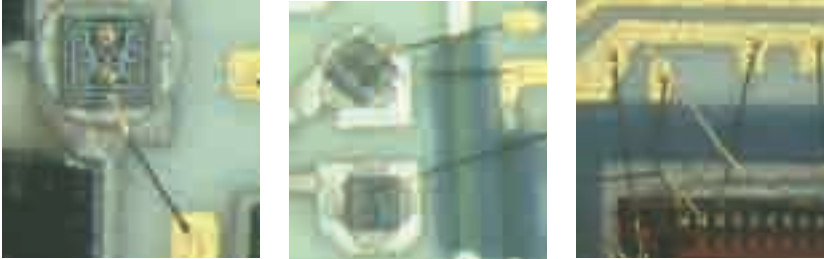
v.l.n.r.: Abgerissener Bonddraht / fehlender Bonddraht / mechanische Beschädigung
