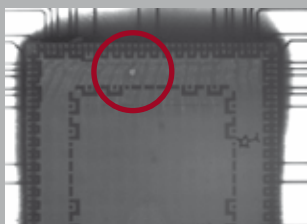
FlipChip underfill void
