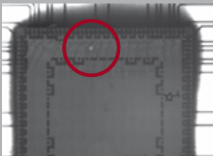
FlipChip underfill void
