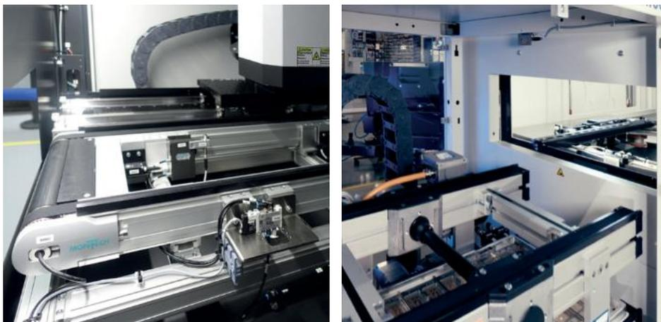
*Mit den neuen Handlingsoptionen Heavy Flex von Viscom lassen sich erstmals auch sehr schwere Prüfobjekte vollautomatisch mit 3D-AOI und 3D-AXI in der Prozesslinie prüfen. (Foto Viscom AG)*
