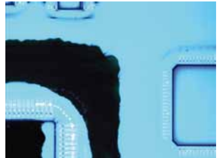
Das Viscom S3088 CCI Inspektionssystem prüft den Schutzlack elektronischer Baugruppen
