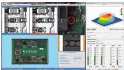
Paste-Uplink AOI: Verknüpfung der SPI-Bilddaten, Prüfergebnisse & Messwerte mit AOI/AXI Daten zur Darstellung am Nachklassifikationsplatz
