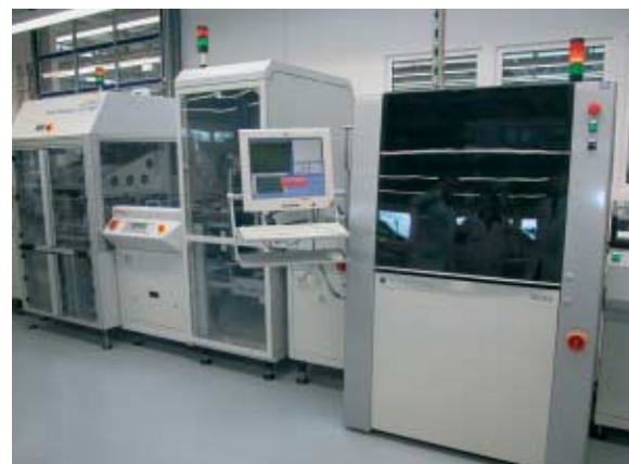
Prüfung von Lötstellen mit bleifreiem Lot mit der Viscom S6055
