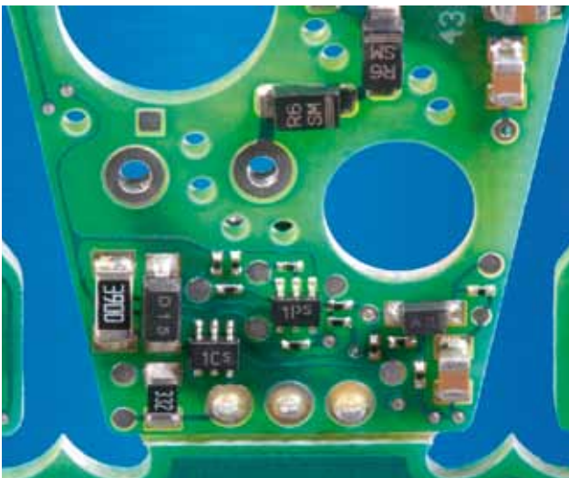
Zündelektronik bleifrei mit 0201-Bauteilen
