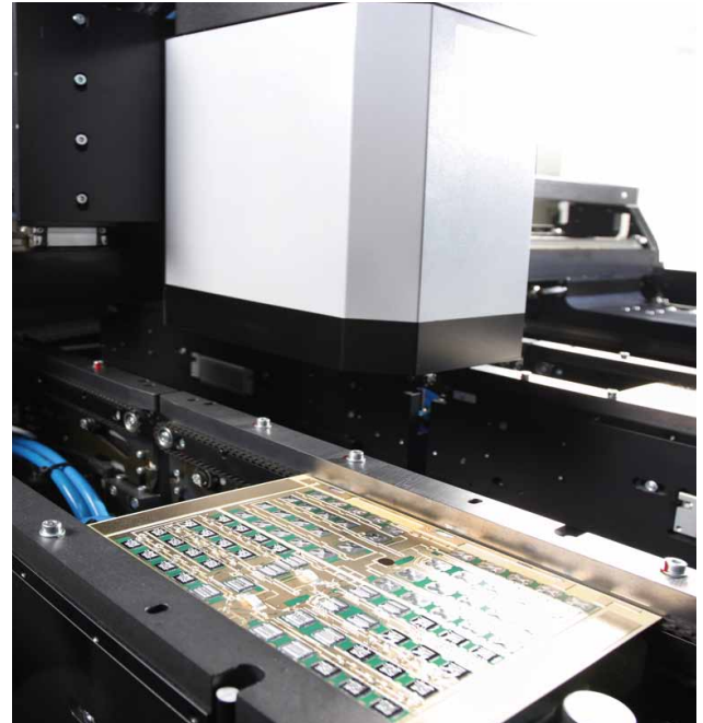
Bonddrahtinspektion mit der Viscom S6056BO
