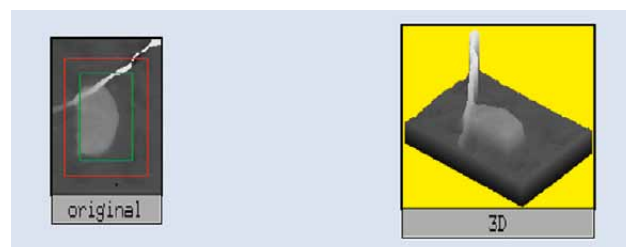
SPI-Ansicht des Handschuhfadens in 2D und 3D
