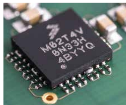
Typisches Bauteil mit verdeckten Lötstellen
