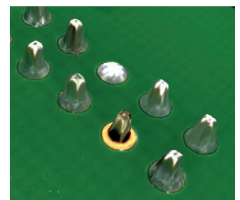
Fehlende Benetzung (vorne) und fehlender Pin (hinten)
