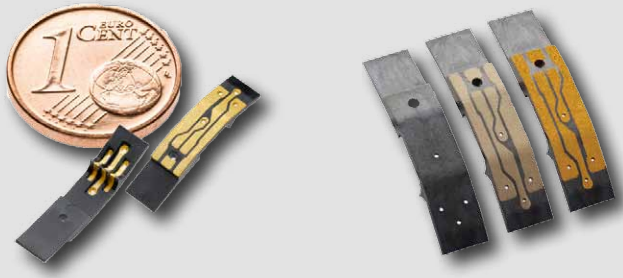
3D-MID-Produkt: Mikrofonhalter für Hörgeräte
