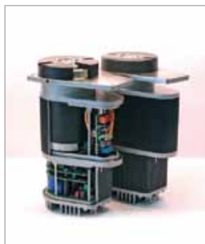
Servoeinheit mit interner Elektronik
