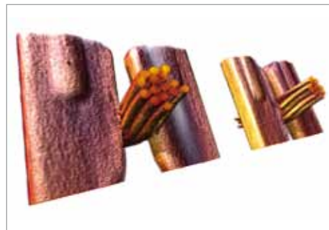
Schneidklemmverbindungen (Durchmesser der Drahtbündel = 1 mm)
