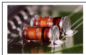
Abb. 2: IPC-A-610D, 8-50: Seitenlänge der Lötstelle am Melf
