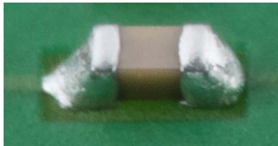
Abbildung 7: Die Lotmenge an den untersuchten CC01005-Bauelementen ist vergleichsweise unauffällig
