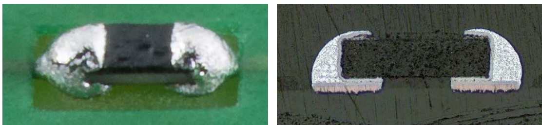
Abbildung 6: Die Ausprägung der Lötstellen zeigt das verhältnismäßig hohe Lotangebot bei Widerständen (links) und in einem beispielhaften Querschliff (rechts)
