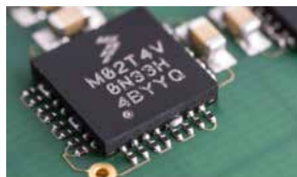
Ausschnitt einer typischen Baugruppe mit verdeckten Lötstellen (QFN)
