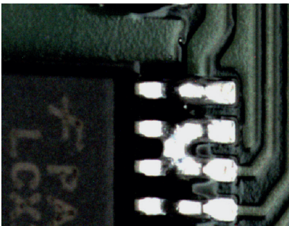
焊接后的焊膏桥接
