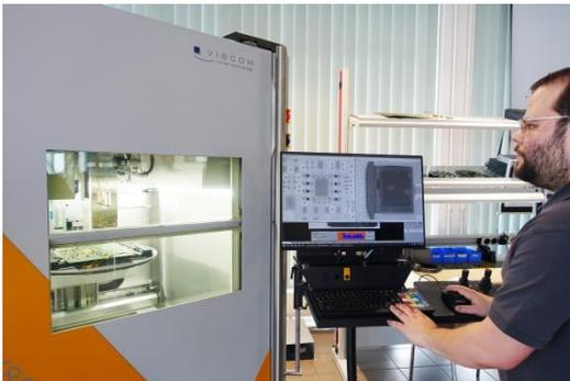
Viscom Röntgensystem prüft im SMT Technologiecenter Anzahl und Größe von Voidflächen
