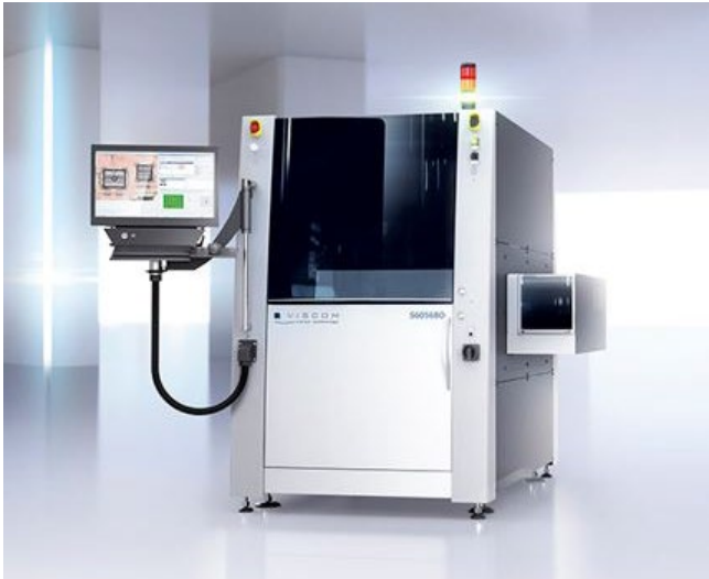
3D-Bond-System S6056BO von Viscom für eine zuverlässige und wiederholgenaue Inline-Inspektion
