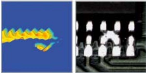
Pastenbrücken nach dem Pastendruck und nach dem Löten
