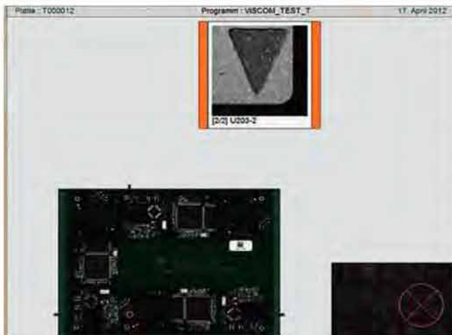
Bild 3a: Image-Uplink: Darstellung von SPI-Fehlerbildern am AOI-Nachklassifikationsplatz.
