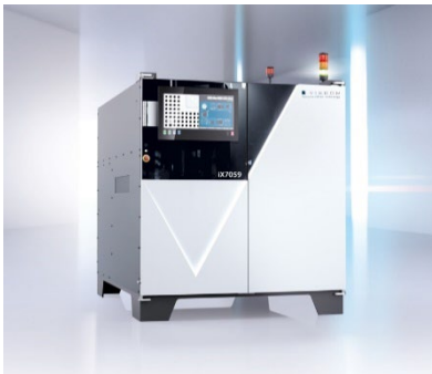
Die iX7059 PCB Inspection XL punktet u. a. mit einem schnellen und dynamischen 3D-AXI-Bildaufnahmeverfahren
