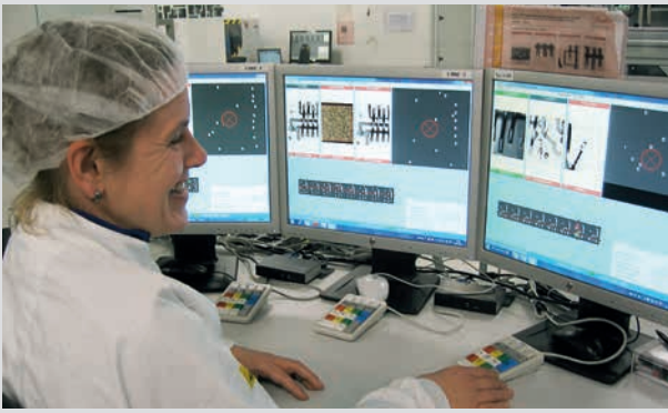
Ein Nachsichtsarbeitsplatz für drei Inspektionssysteme
